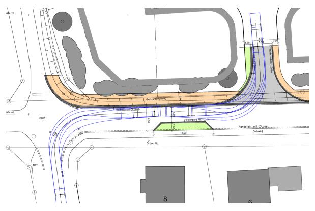
Die erste Variante sieht eine Einengung vor der Einmündung des Bussardweges vor. Die eingezeichneten Schleppkurven weisen nach, dass die Ein- und Ausfahrt zum Bussardweg für
