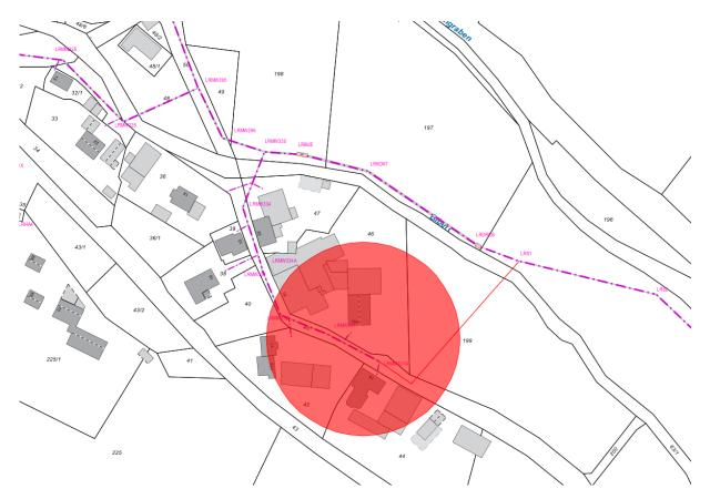
In Leonrod besteht eine Mischwasser-Kanalisation. Das im Regenwetterfall anfallende Wasser wird durch einen Stauraumkanal zwischen den Schächten LRBUE (Leonrod-Beckenüberlauf) und LRDROS (Leonrod-Drosselschacht) zwischengespeichert und nach Füllung dieser Rückhaltung in die Bibert entlastet. Der Überlauf des Stauraumkanals liegt verhältnismäßig hoch, um auch bei höherem Wasserstand der Bibert entlasten zu können.
