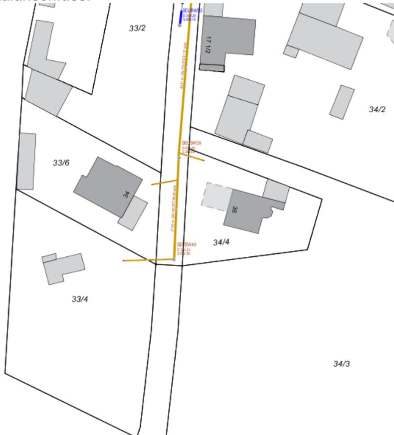
Der bestehende Schmutzwasserkanal endet ca. 1,8 m von der südlichen Grundstücksgrenze des Grundstücks FINr. 34/4 in einer Tiefe von ca. 1,65 m. Ein Hausanschluss am Endschacht des Kanals ist möglich. Eine Entwässerung eines möglichen Kellergeschosses im Freispiegel ist nicht möglich.
