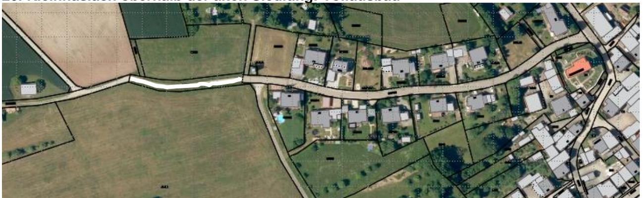
Ca. 120 m lang, 3,20 m breit, Asphalttragschicht Einbaudicke 12 cm
