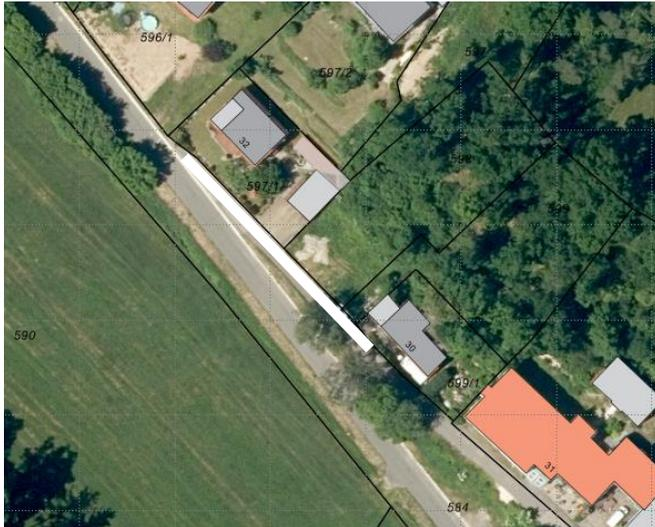
240 m<sup>2</sup>, Asphaltdeckschicht Einbaudicke 4 cm
