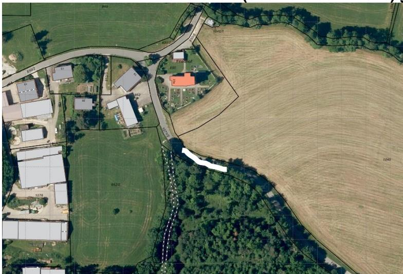
Ca.12,5 m<sup>2</sup> Asphalttragschicht Einbaudicke 10 cm
