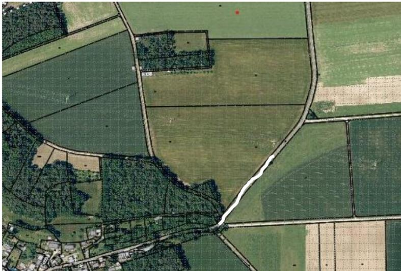
**70 m lang, 1,20 m breit** Asphalttragschicht Einbaudicke 10 cm
