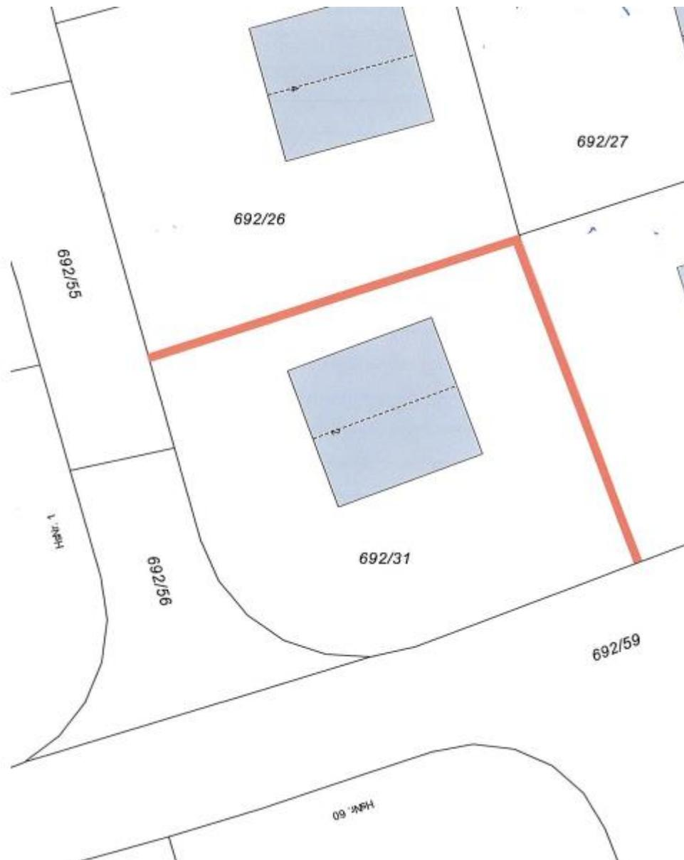
Die Errichtung der Stützmauer stellt ein verfahrensfreies Bauvorhaben nach Art. 57 Abs. 1 Nr. 7 Buchstabe a) BayBO dar, da sie eine Höhe von bis zu 2 Meter nicht überschreitet.
